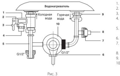
1. Сливной предохранительный клапан.
